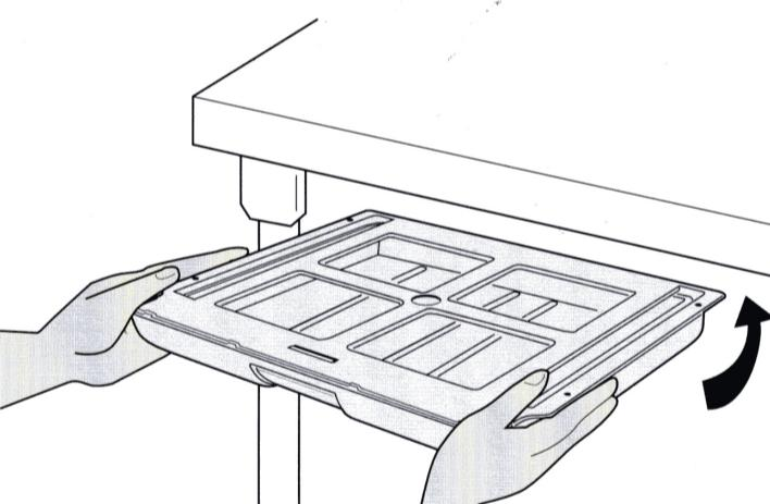
●前後をまちがわぬようトレーの引き出し面を確認し、接着させたい面へ両手で持ち上げるようにしてしっかりと固定してください。
